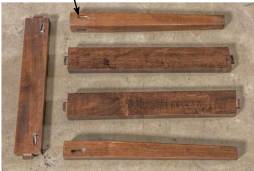
mortis & tenon construction
